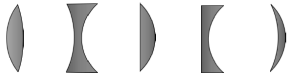
పటం-6(ఎ): ద్విసంభాజక కటకం (biconvex lens), పటం-6(బి): ద్విసంభాజక కటకం (biconcave lens), పటం-6(సి): సమతల కుంభాకార కటకం (plano-convex lens), పటం-6(డి): సమతల కుంభాకార కటకం (plano-concave lens), పటం-6(ఇ): కుంభాకార కటకం (convex lens).
