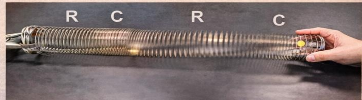
Longitudinal wave in a slinky
